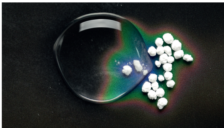
Εικόνα 6: Διεξαγωγή πειράματος πάνω από θερμογραφικό «χαρτί», το οποίο μεταβάλλει το χρώμα του ανάλογα με την μεταβολή θερμοκρασίας.
