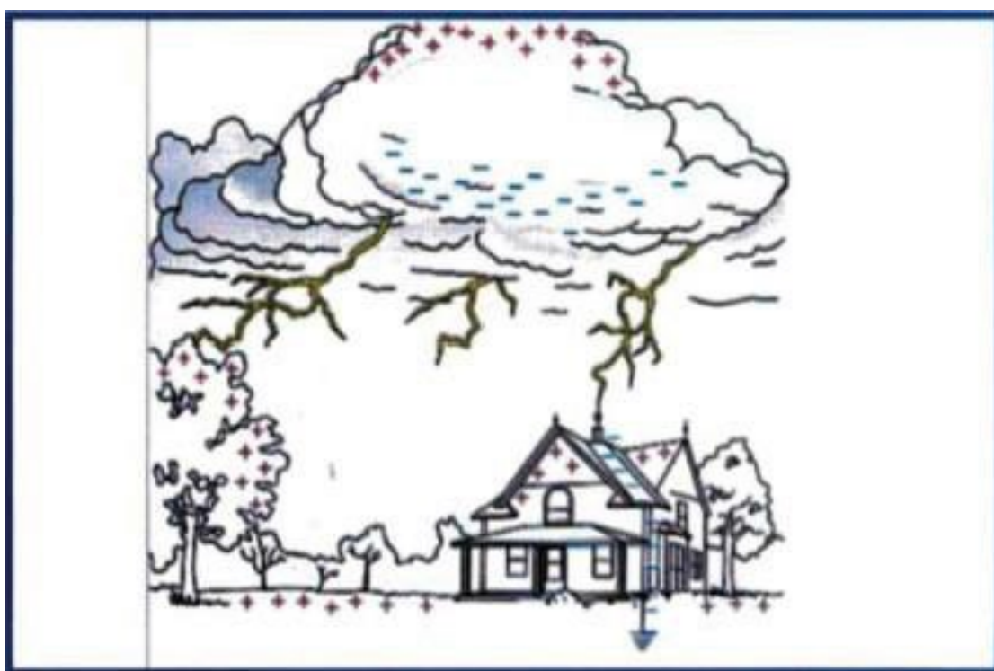
Εικόνα 1: Η συσσώρευση φορτίου στην επιφάνεια του νέφους επάγει θετικό φορτίο στην επιφάνεια της Γης. Εικόνα (Α).
