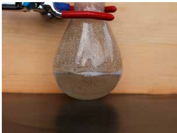
Εικόνα 5.55: Διάλυση μετάλλου σε οξύ. Διακρίνεται ο έντονος αφρισμός του διαλύματος λόγω έκλυσης διυδρογόνου.
