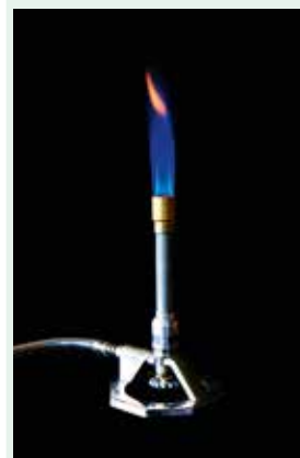
Εικόνα 2.20: Μπλε φλόγα λύχνου με ρύθμιση του εισερχόμενου αέρα.
