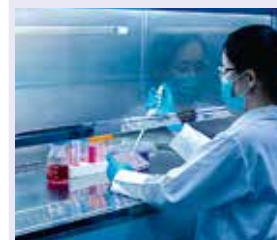
Εικόνα 1.12: Όργανα, σκεύη και αντιδραστήρια εντός απαγωγού αερίων. Ο απαγωγός είναι ουσιαστικά ένας απορροφητήρας μέσα σε ένα ντουλάπι. Στην μπροστινή πλευρά υπάρχει προστατευτικό τζάμι.
