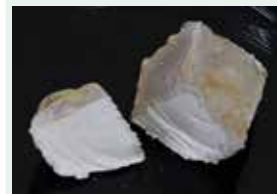
Εικόνα 2.26: Μεταλλικό νάτριο. Στην επιφάνειά του έχει σχηματιστεί οξειδίο, καθώς αντιδρά με το οξυγόνο της ατμόσφαιρας.
