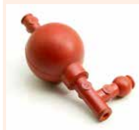
Εικόνα 6.23: Πουάρ τριών βαλβίδων για την αναρρόφηση υγρών.
