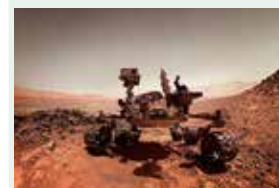
Εικόνα 2.33: Όχημα μελέτης του πλανήτη Άρη. Λαμβάνει ενέργεια από τον Ήλιο, μέσω φωτοβολταϊκών υψηλής απόδοσης βασισμένων στο γερμάνιο (Ge).
