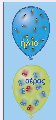
Εικόνα 5.4. Το ξεφούσκωμα των μπαλονιών που περιέχουν He φανερώνει το εξαιρετικά μικρό μέγεθος των ατόμων του He (μικρότερο από τους πόρους του λάστιχου που έχουν απειροελάχιστη διάμετρο).
