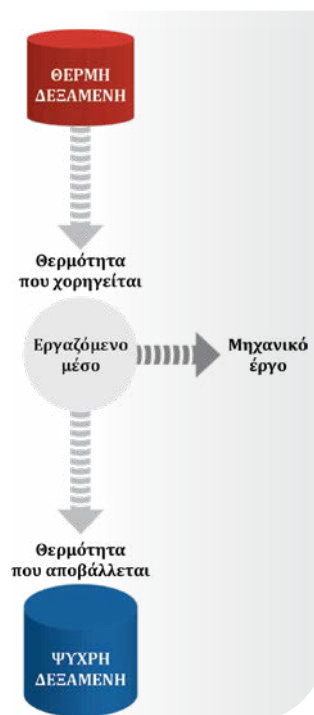
3.6.9: Τα μέρη και η λειτουργία μιας θερμικής μηχανής.
