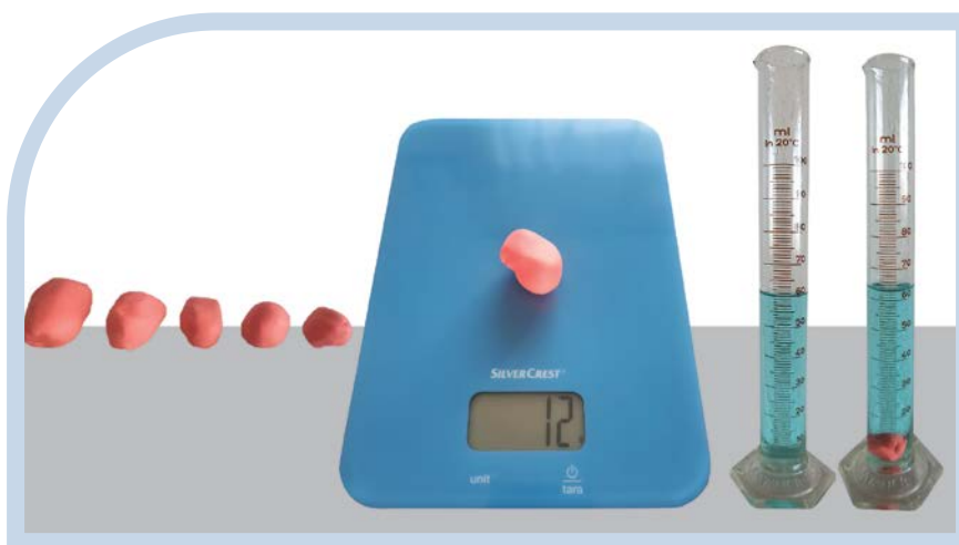
Εικόνα 2.3.10: Τα πέντε κομμάτια πλαστελίνης, η ζύγιση και η ογκομέτρηση
