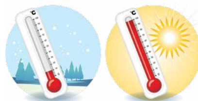
Εικόνα 3.2.6: Η αύξηση της θερμοκρασίας οδηγεί στην αύξηση του όγκου του οινοπνεύματος σε ένα θερμόμετρο οινοπνεύματος και συνεπώς στην αύξηση του ύψους της στήλης του.
