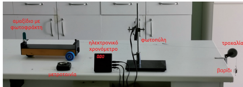
Εικόνα 1 Ευθύγραμμη ομαλά μεταβαλλόμενη κίνηση με μία φωτοπύλη
