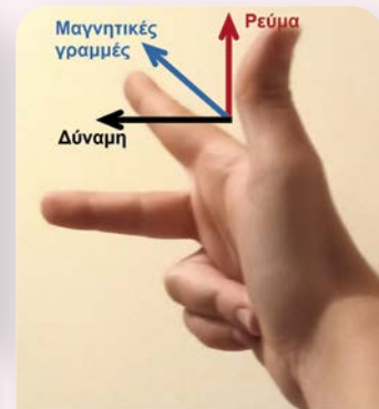
Εμπειρικός κανόνας του δεξιού χεριού για την εύρεση της φοράς της δύναμης Laplace
