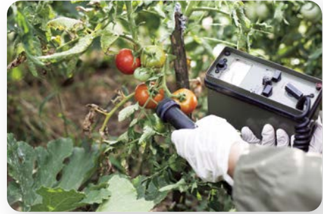
Μέτρηση ραδιενέργειας σε λαχανικά
