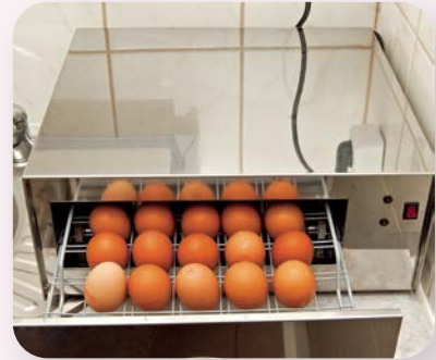
Συσκευή απολύμανσης αυγών με ακτίνες UV
