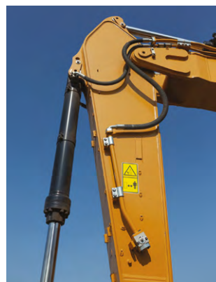
Εικόνα 4. Χρήση υδραυλικών κυλίνδρων σε εκσκαφείς
