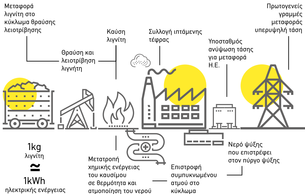
Εικόνα 3. Ηλεκτροπαραγωγικό σύστημα με βάση την καύση άνθρακα
