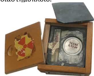
Εικόνα 4.1.20: Ραδιενεργή πηγή θαλλίου-204. Όταν δεν χρησιμοποιείται καλύπτεται με φύλλα μολύβδου.
