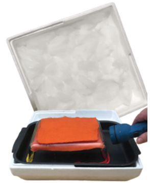
Εικόνα 4.2.4: Πάνω το κουτί με τα παγάκια και το αλάτι. Κάτω η συνολική διάταξη.
