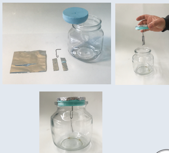
Εικόνα 1.2.8: Η κατασκευή του ηλεκτροσκοπίου.
