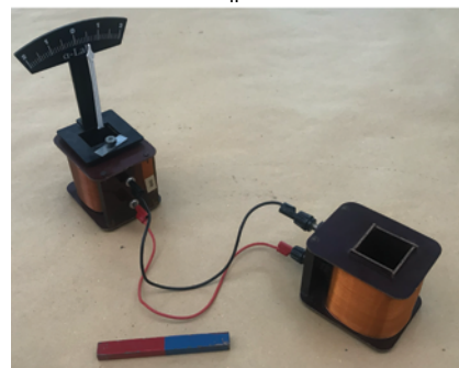
Εικόνα 2.3.6: Γαλβανόμετρο συνδεδεμένο με πηνίο.
