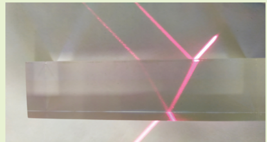
Εικόνα 3.2.6: Ανακλάσεις και διαθλάσεις σε γυάλινο πλακίδιο.
