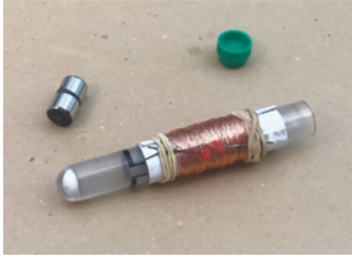
Εικόνα 2.3.8: Τα υλικά από τα οποία αποτελείται η γεννήτρια.
