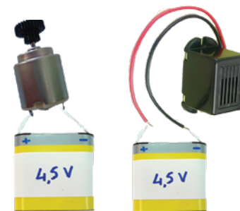
Εικόνα 1.4.26: Σύνδεση κινητήρα και βομβητή με μπαταρία.
