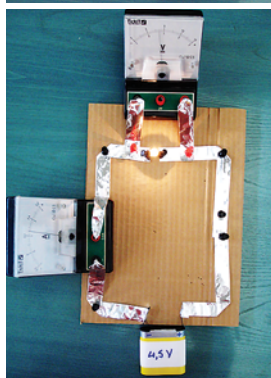
Εικόνα 1.4.23: Το κύκλωμα της εικόνας 1.4.22 φτιαγμένο με αγωγούς από αλουμινόχαρτο.
