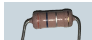
Εικόνα 1.5.18: Αντίσταση άνθρακα 0,26Ω και ανοχή 5%.
