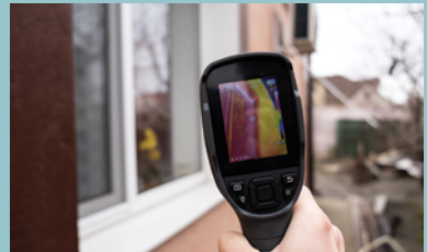
Εικόνα 3.3.4: Η θερμική κάμερα εντοπίζει διαρροές θερμότητας.
