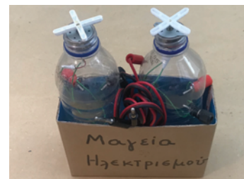
Εικόνα 2.3.12: Πλαστικά μπουκάλια με κινητήρες από CD player.
