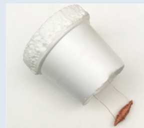
Εικόνα 1.8.14: Στήριξη της αντίστασης στο καπάκι.
