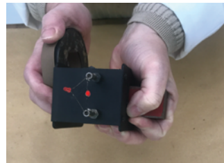
Εικόνα 2.3.3: Δύο Led συνδεδεμένα σε πηνίο ανάβουν πλησιάζοντας και απομακρύνοντας έναν μαγνήτη.
