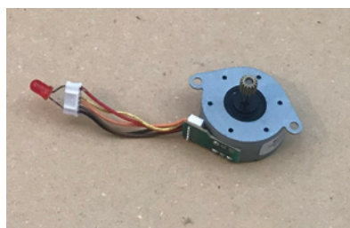
Εικόνα 2.3.11: Κινητήρας παλιού ηλεκτρονικού υπολογιστή, συνδεδεμένος με led.
