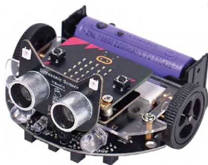
Εικόνα 3.2.6. Παράδειγμα ρομποτικού οχήματος που βασίζεται σε Micro:Bit.
