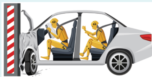
Εικόνα 5.1.9: Δοκιμή σύγκρουσης (crash test) αυτοκινήτου σε ακίνητο εμπόδιο. Αντί για επιβάτες υπάρχουν ειδικές κούκλες (ανδρείκελα).
