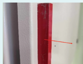
Εικόνα 3.2.1.17: Μαγνήτης στην επιφάνεια κατακόρυφης μεταλλικής πόρτας. Η κάθετη αντίδραση είναι οριζόντια
