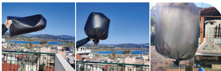
Εικόνα 3.3.5.7. Αερόστατο θερμού αέρα με χρήση μαύρης σακούλας σκουπιδιών
