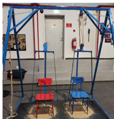
Εικόνα 5.1.10: Αριστερά η διάταξη στην μπλε καρέκλα με κινητή τριπλή τροχαλία και στην κόκκινη καρέκλα με μονή ακίνητη τροχαλία. Δεξιά φαίνεται η μικρή αλλά εύκολη άνοδος
