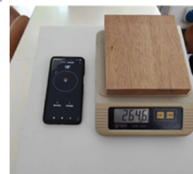
Εικόνα 3.2.1.8: Ένδειξη ζυγού υπό γωνία ως προς το οριζόντιο επίπεδο
