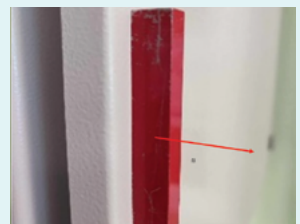
Εικόνα 3.2.1.17: Μαγνήτης στην επιφάνεια κατακόρυφης μεταλλικής πόρτας. Η κάθετη αντίδραση είναι οριζόντια
