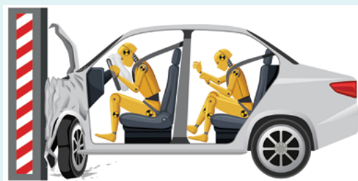
Εικόνα 5.1.9: Δοκιμή σύγκρουσης (crash test) αυτοκινήτου σε ακίνητο εμπόδιο. Αντί για επιβάτες υπάρχουν ειδικές κούκλες (ανδρείκελα).
