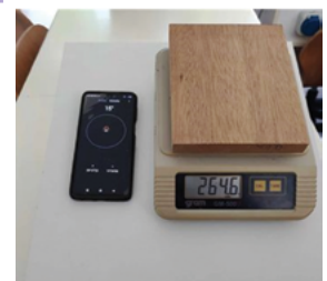
Εικόνα 3.2.1.8: Ένδειξη ζυγού υπό γωνία ως προς το οριζόντιο επίπεδο
