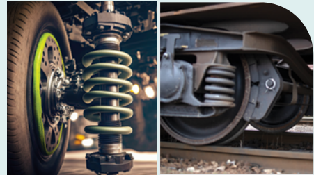
Εικόνα 1.2.11: Ελατήρια στο σύστημα ανάρτησης αυτοκινήτου και τρένου
