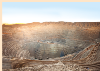
Εικόνα 3.6.9 Το βαθύτερο ορυχείο ανοικτής εκσκαφής στον κόσμο, Bingham Canyon Mine, Utah, USA, με βάθος 1,2 χλμ.
