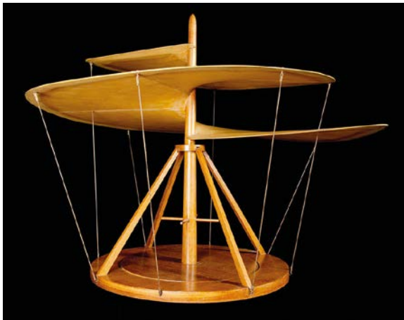
Σχέδιο έλικα ιπτάμενης μηχανής
