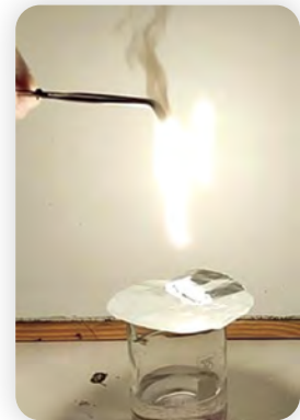
Το μαγνήσιο καίγεται με το οξυγόνο με εκτυφλωτική λάμψη. Παλιότερα η αντίδραση χρησιμοποιήθηκε στα φλας των φωτογραφικών μηχανών.
