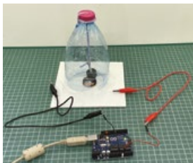
Εικόνα 43. Απλός εκπαιδευτικός σεισμογράφος με σύνδεση στον μικροελεγκτή Arduino
