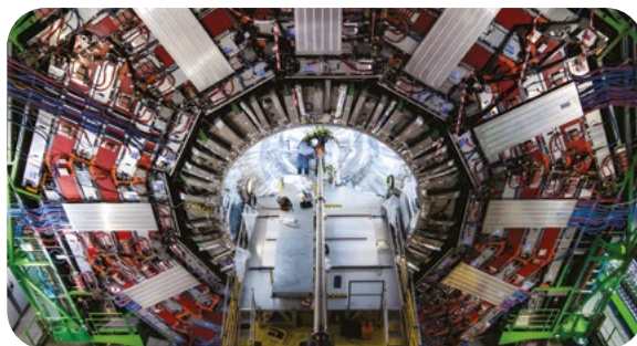
Διάταξη ανιχνευτή σωματιδίων στο CERN
